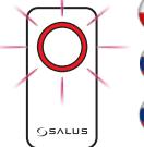
Sieć ZigBee otwarta, trwa wyszukiwanie urządzeń
